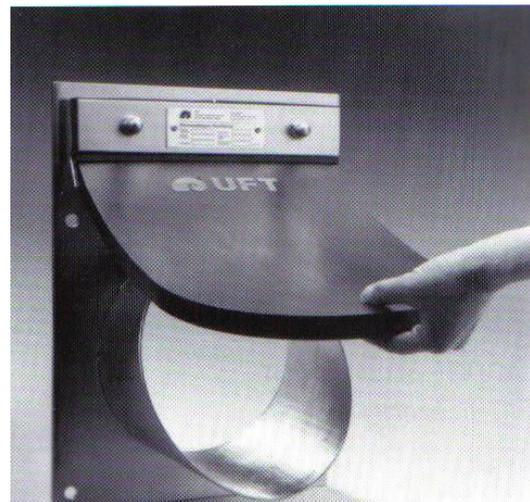
La lengüeta de elastómero especial permite abrir con gran facilidad en el sentido del flujo y permanece estanca en cuanto hay contra-presión aguas abajo.
